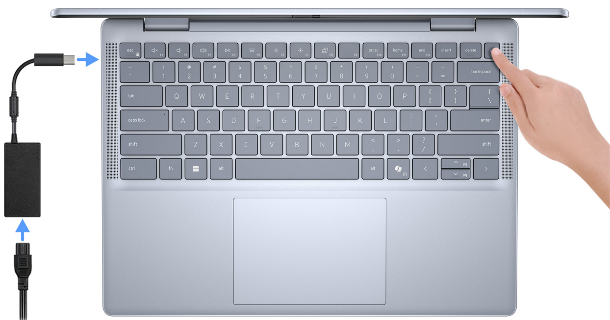
Rysunek 8. Podłącz zasilacz i naciśnij przycisk zasilania
