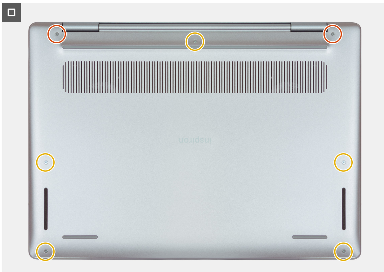
Rysunek 15. Wkręcanie śrub
