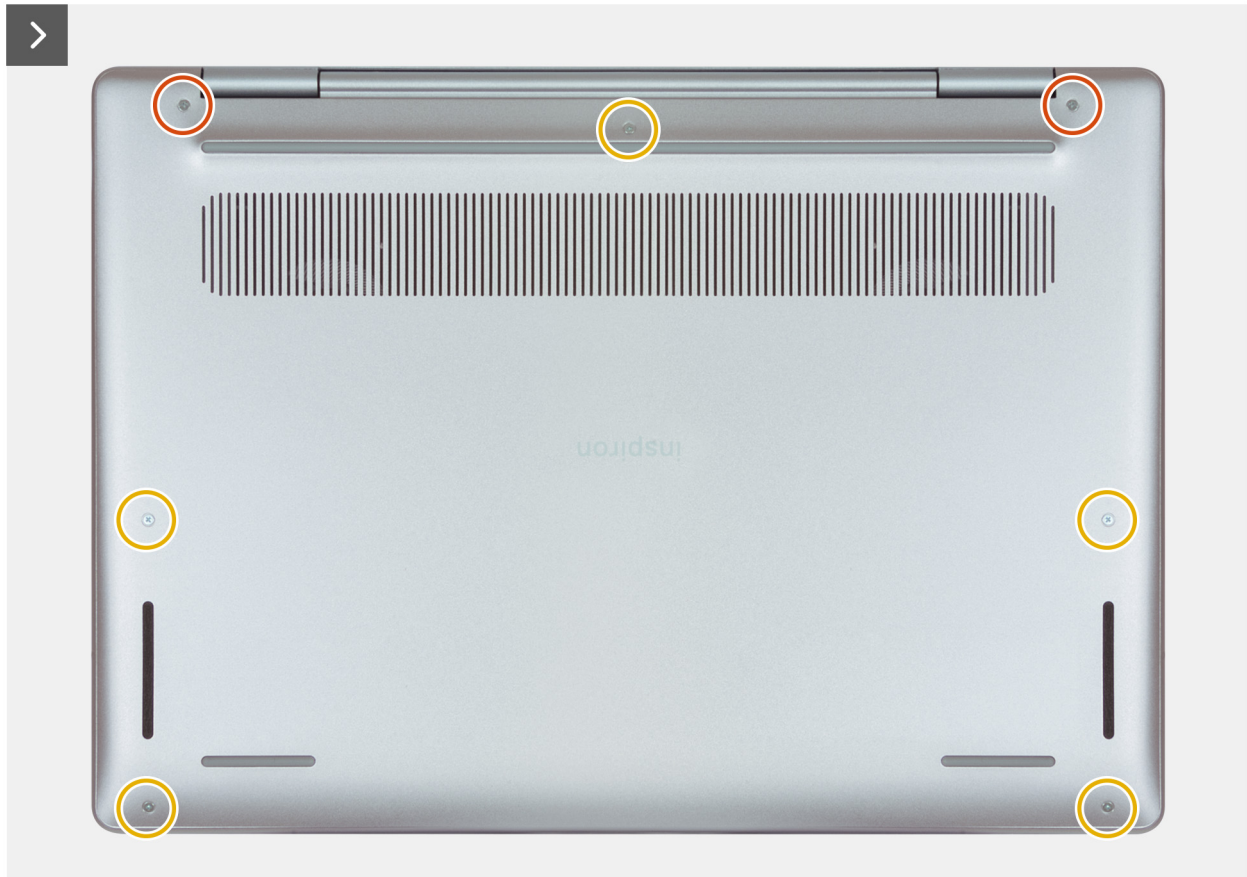
Rysunek 10. Wykręcanie śrub
