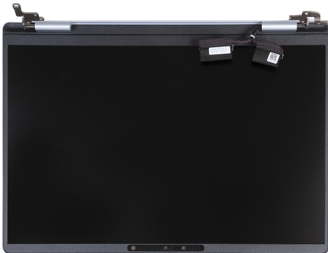
Rysunek 33. Zestaw wyświetlacza.
