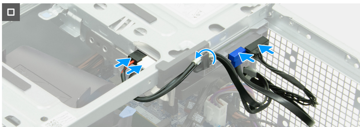
Rysunek 44. Instalowanie wnęki napędu
