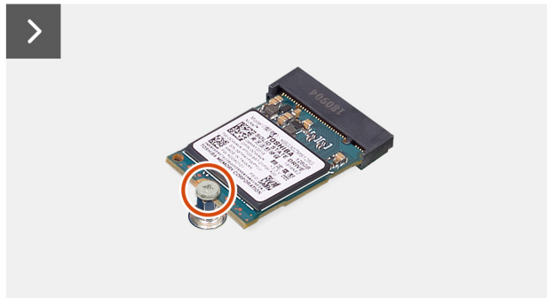
Rysunek 28. Wymontowywanie dysku SSD M.2 2230
