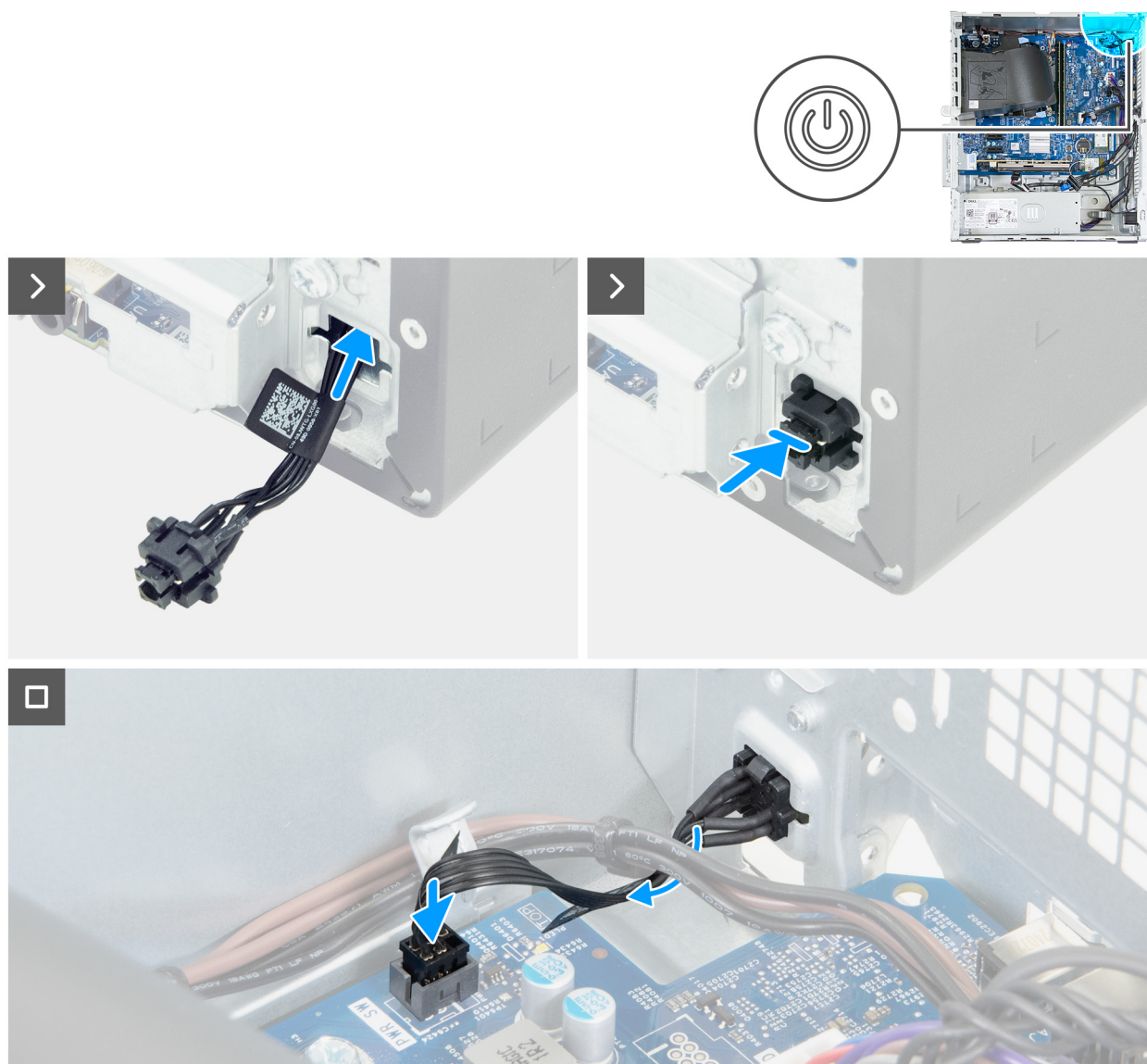
Rysunek 50. Instalowanie przycisku zasilania
