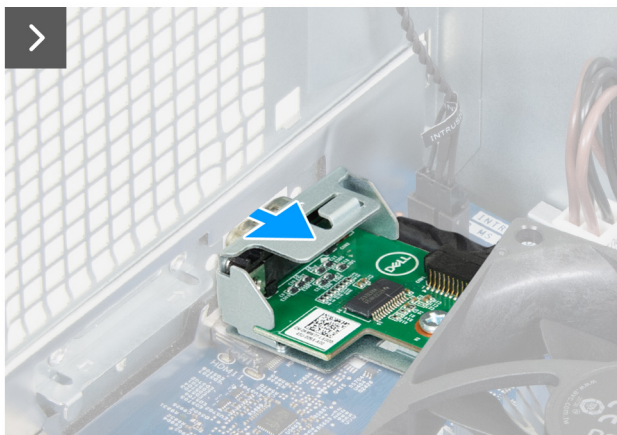
Rysunek 56. Wymontowywanie modułu portu szeregowego
