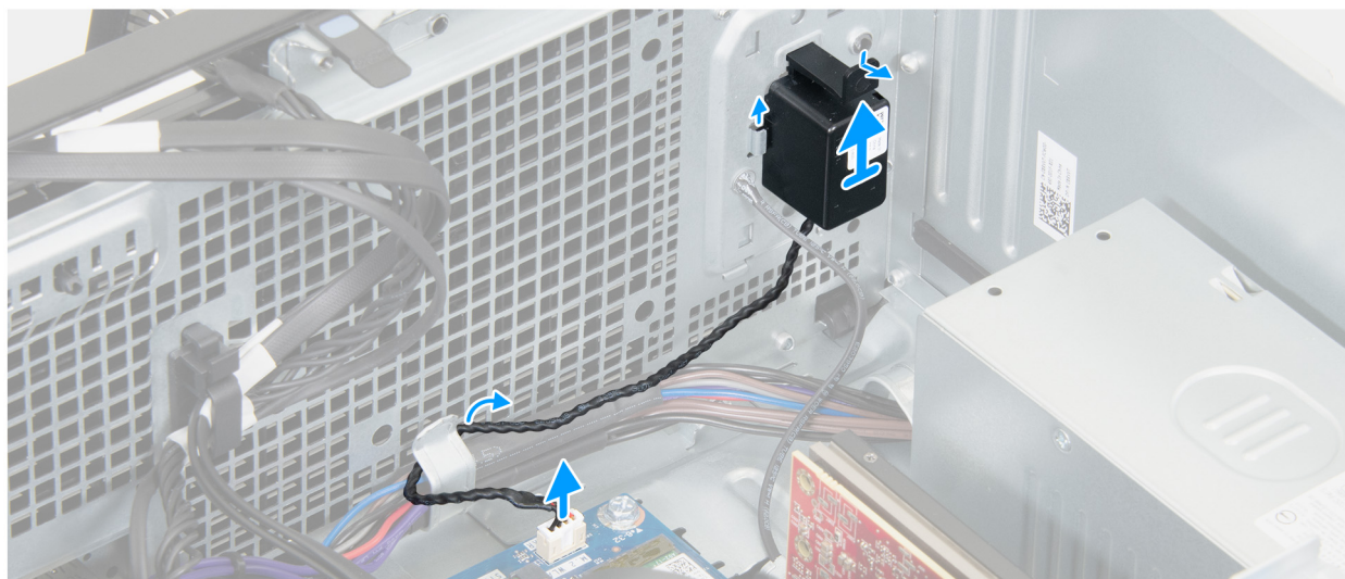
Rysunek 24. Wymontowywanie głośnika wewnętrznego
