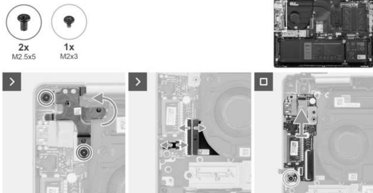
Rysunek 31. Wymontowywanie płyty we/wy
