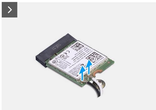
Rysunek 27. Wymontowywanie karty sieci bezprzewodowej
