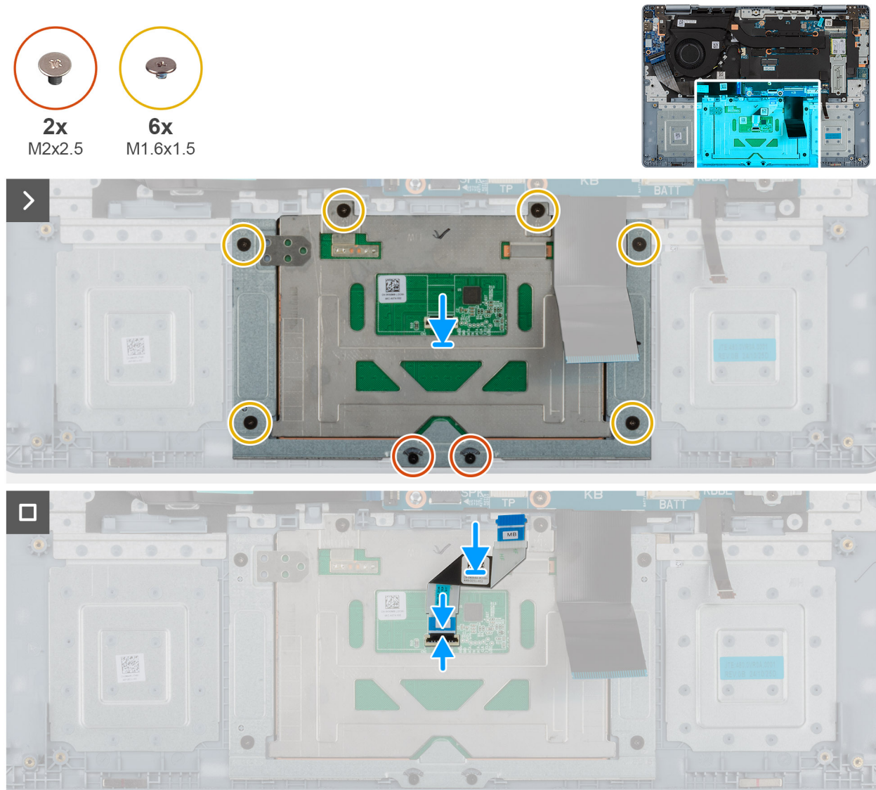
Figure 37. Installation du pavé tactile
