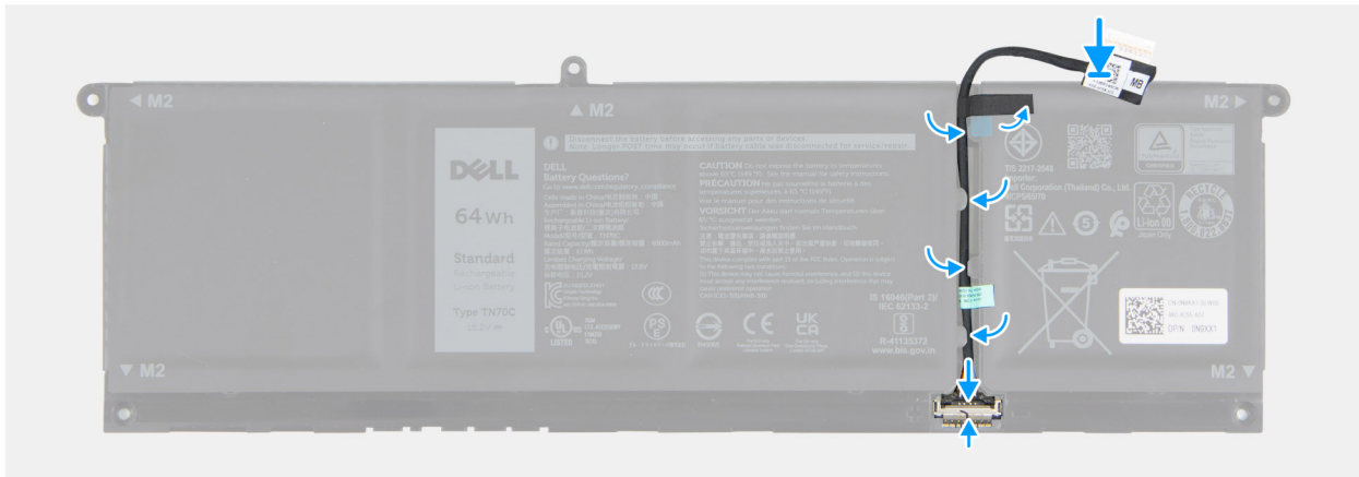
Figure 21. Connexion du câble de la batterie
